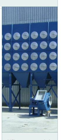
"El amperaje gastado por el motor del ventilador es debido al trabajo realizado al mover las toneladas de aire que el sistema requiere y venciendo un a resistencia generada por el ducto"
